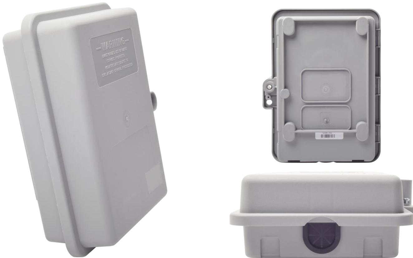
Fabricado para soportar ambientes exteriores, ofrece una base desmontable con arandela de goma, una bisagra oculta y patas extendidas pre moldeadas.
